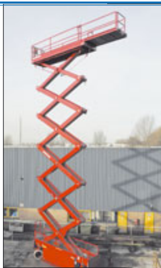
28,2 Meter Arbeitshöhe bietet die N-265EL13 von Holland Lift
