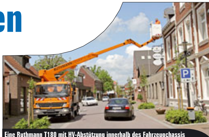
Eine Ruthmann T180 mit HV-Abstützung innerhalb des Fahrzeugchassis
